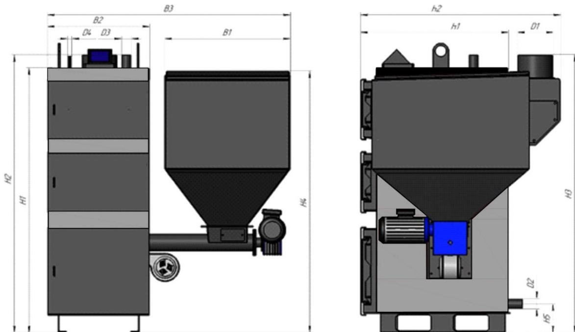
Рисунок 1. Габаритные размеры BOSS, мощностью 11- 270 кВт.
