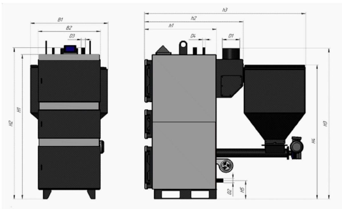
Рисунок 2. Габаритные размеры BOSS, мощностью 330-470 кВт.
